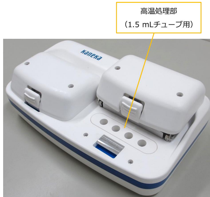
図 3-1：装置本体高温処理部（右側）
